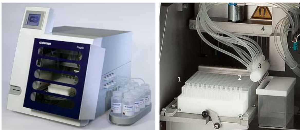
Abbildung 10: Chemagic Prepito der Firma chemagen Biopolymer-Technologie AG, Außen- und Innenansicht. Rechtes Bild: Einwegehülsen für magnetisierbare Stäbe (1), Titerplatte für Pufferlösungen (2), Membranpumpen zur automatisierten Füllung der Titerplatte, parallel magnetisierbare Stäbe (unter 4)
