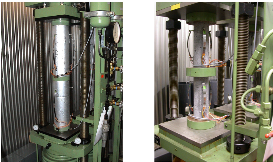
Bild 3.3: Je zwei Leichtbetonproben wurden übereinander in die hydraulische Belastungseinrichtung für die Kriechversuche eingebaut (links: mit einer mit Butylkautschuk beschichteter Alufolie versiegelte Leichtbetonproben \varnothing \times h 150 mm x 450 mm; rechts: unversiegelt gelagerte Proben \varnothing \times h 75 mm x 225 mm)
