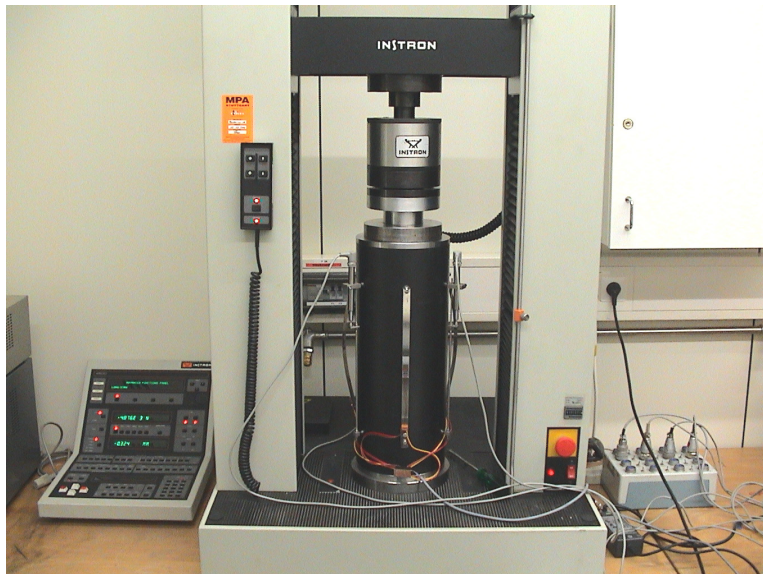
Bild 3.2: Der Eichprobekörper mit eingebauten induktiven Wegaufnehmern und Messstäben wurde in eine mechanisch gesteuerte Prüfmaschine eingebaut und kontrolliert belastet
