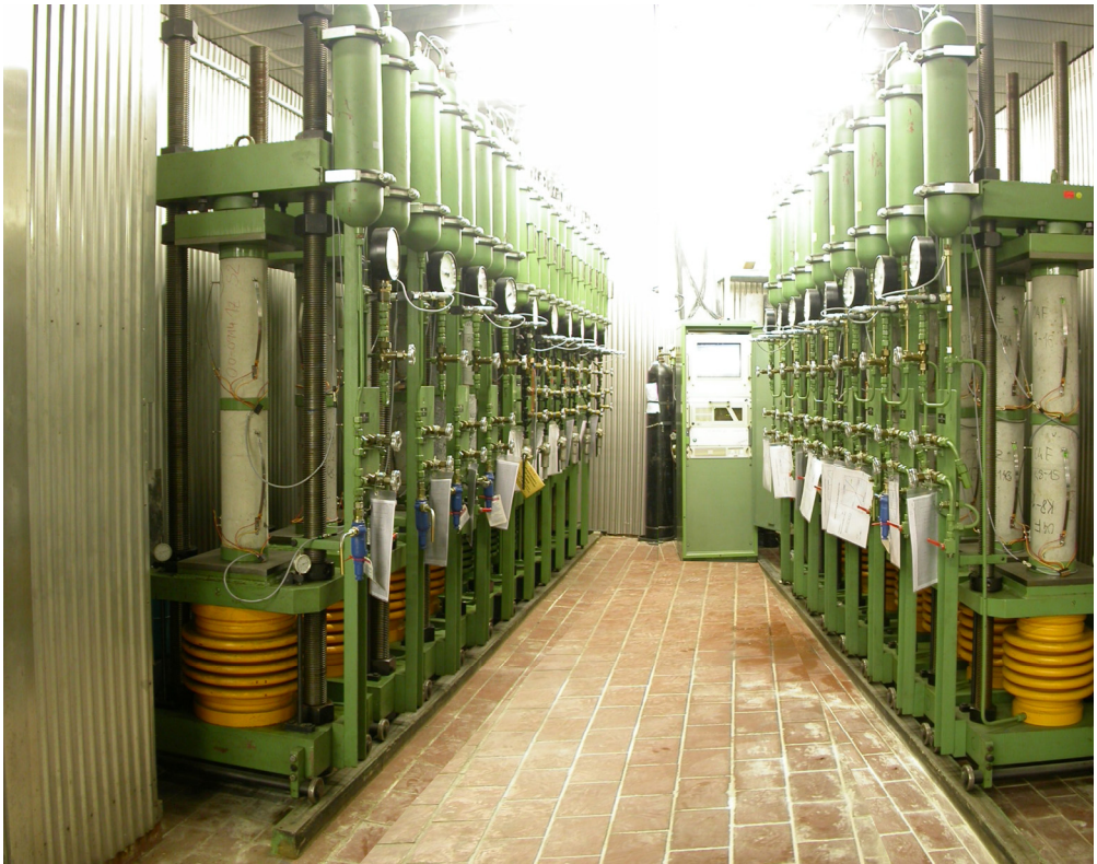
Bild 3.4: Blick in die Klimakammer mit den Kriechständen (rechts und links) sowie der Messanlage (hinten)
