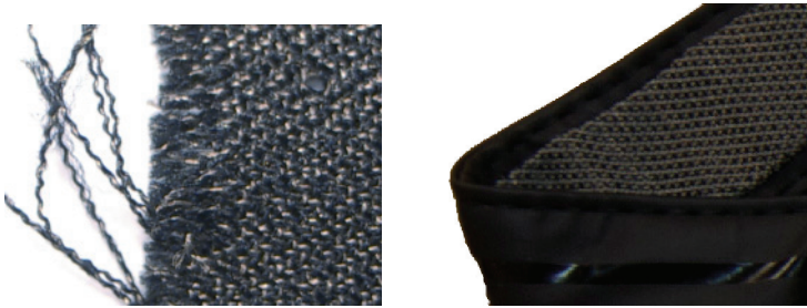
Abbildung 2.13: Textile mit Leitfähigkeit auf Silberbasis (links) und textile Trockenelektrode eines Pulsmessers.
