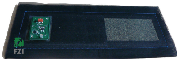
Abbildung 5.17: Umsetzung der textilen Elektrode mit Impedanzwandlerschaltung.
