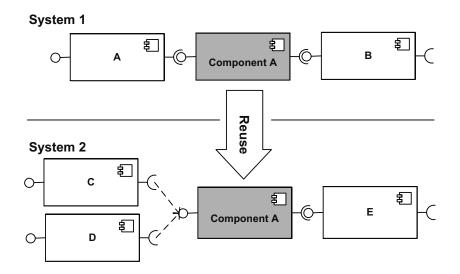
Figure 1.3.: Component reuse
