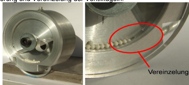
Abbildung 15: Kugelmagazin zur Magazinierung und Vereinzelnung der Ventilkugeln
