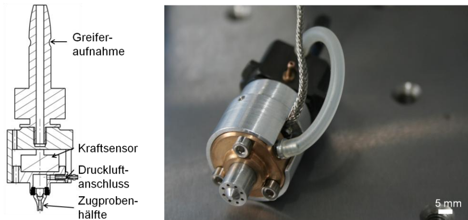
Abbildung 15: Kraftsensitiver Greifer: links: technische Zeichnung mit Zugprobe; rechts: reale Baugruppe
