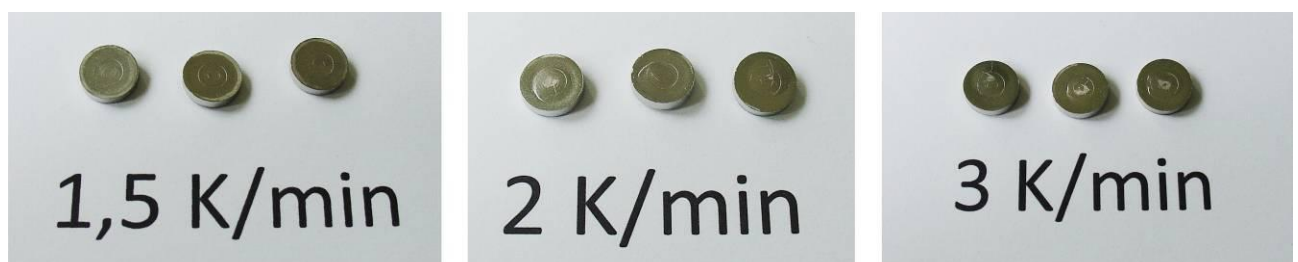
Abb. 10: Blasenbildung bei schnellen Heizraten während der thermischen Entbinderung.
