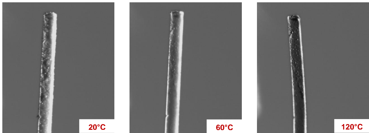
Abb. 12: Veränderung der Probenoberfläche während der therm. Entbinderung.
