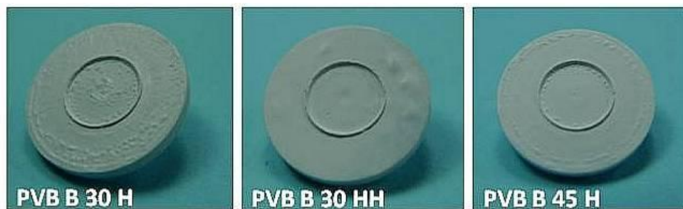
Abb. 7: Aufnahmen der Testscheiben nach 2 Stunden Entbinderungs-dauer im Wasser bei 50 °C.
