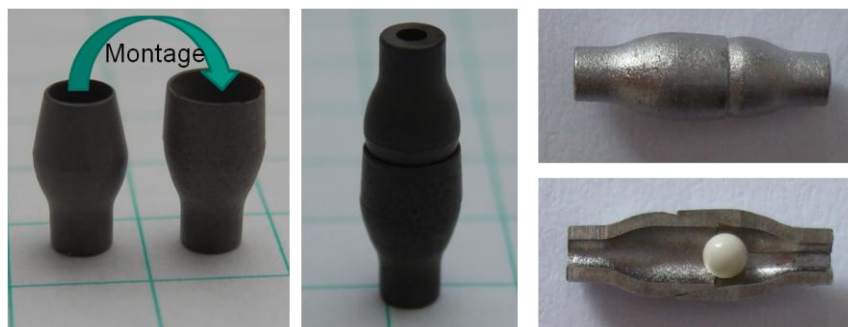
Abbildung 7: Mikrorückschlagventil aus 17-PH Edelstahl
