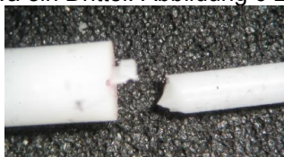
Abbildung 6: Typisches Bruchbild der Polygonwellen (rechts)
