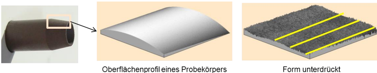
Abbildung 5: Vorgehen bei der Oberflächenmessung eines Fügekegels [Mun-10a, Mun-10b]
