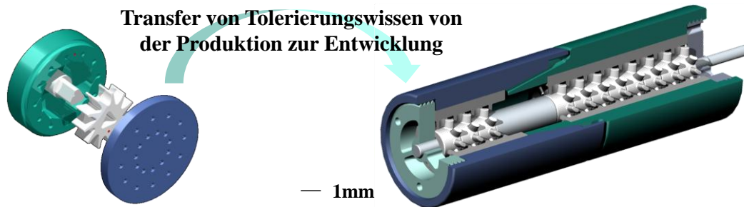
Abbildung 11: Durch die Hilfe von Produktionsdaten zuvor entwickelter Projekte (links) wird die Tolerierung des aktuell zu entwickelnden Projektes „Mikrogasturbine“ vereinfacht (rechts).
