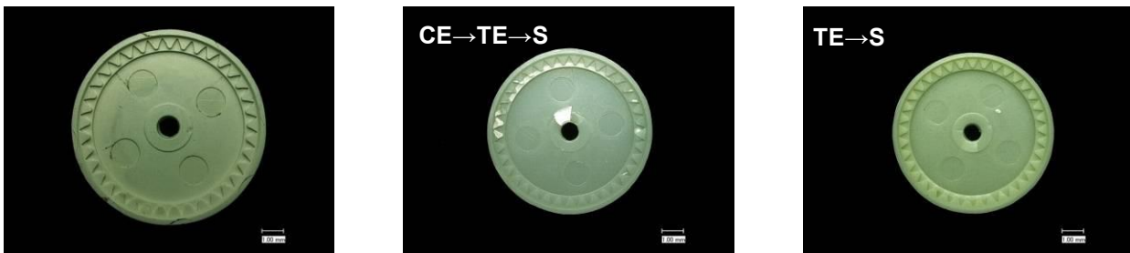
Abb. 8: Getriebegehäuse als Grünling (links) und gesintertes Bauteil (mitte, rechts). Die dabei verwendete Formmasse bestand aus 55 vol% TZ-3YS-E und einem auf PVB B 30 H-PEG 4000 basierten Bindersystem. Die benutzten Abkürzungen bedeuten: CE: chemisches Entbindern, TE: thermisches Entbindern, S: Sintern.
