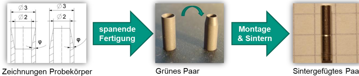
Abbildung 4: Probekörper für die Untersuchung konischer Fügeflächen beim Sinterfügen [Mun-10a]
