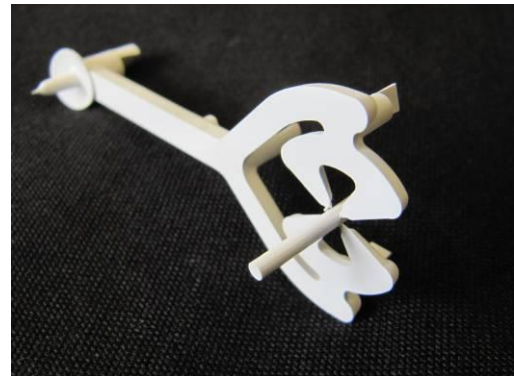
Abb.2: Zylindrisches Bauteil mit 4-Punkt Angussystem; CAD (links) und Grünling (rechts).
