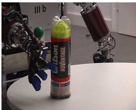
Abb. 7.15: Bildsequenz der Exploration einer Tennisball-Dose mit dem Roboter ARMAR-III, von links nach rechts und von oben nach unten.
