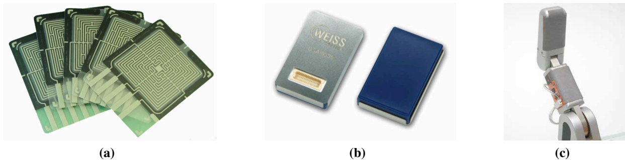
Abb. 2.7: Kommerziell verfügbare taktile Sensoren unterschiedlicher Technologien: FSRs der Fa. Interlink [Interlink, 2011] (a), Modell DSA-9335 der Fa. Weiss [Weiss, 2011] (b)), Robotouch -Sensor der Fa. PPS [PPS, 2011] (c).
