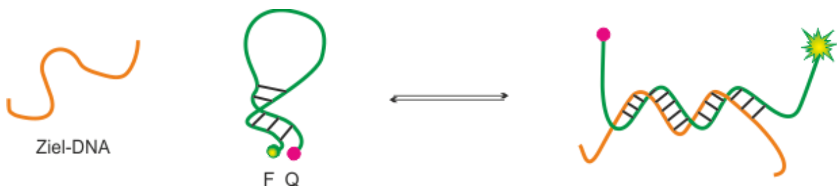
Abb. 28: Molecular Beacon mit Fluorophor (F) und Löscher (Quencher, Q), der an die Ziel-DNA bindet und zu leuchten beginnt
