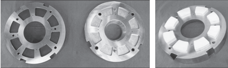
Bild 5-2: Werkzeugisolierung mit keramischen Einsätzen [Ham09a]
