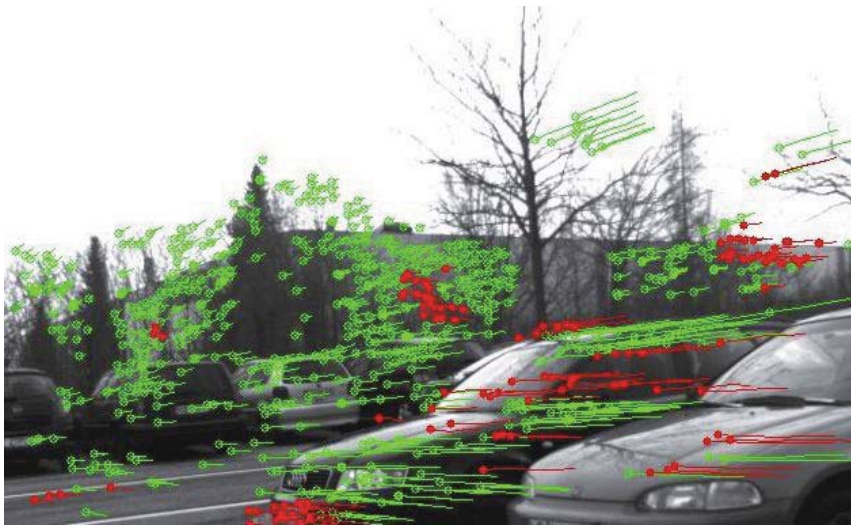
Abbildung 3.1: Extrahierte Verschiebungsvektoren: Ausreißer sind rot eingefärbt.
