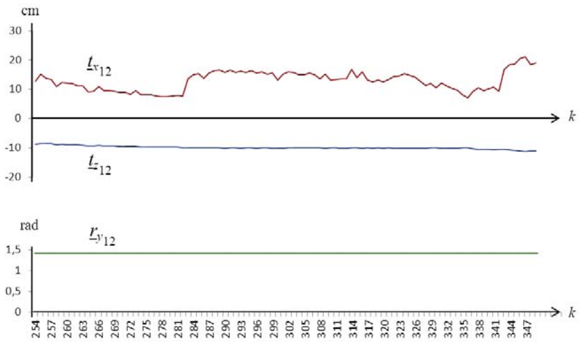
Abbildung 9.8: Geschätzte Parameter des Bewegungsausgleichs ( C , zwei translatorische und ein rotatorischer Parameter) der der Zwei-Kurven-Simulation zwischen den Modulen \mathcal{M}_1 und \mathcal{M}_2 .
