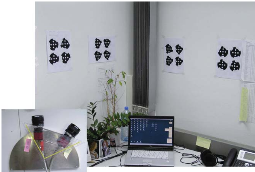
Abbildung 1.6: Anordnung von Kalibriermustern mit unterschiedlichen aber bekannten Eigenschaften zur Kalibrierung einer MMD-Zweikameraanordnung.
