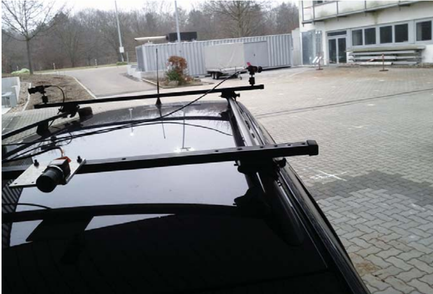
Abbildung 9.10: Testfahrzeug mit Kameraaufbau.
