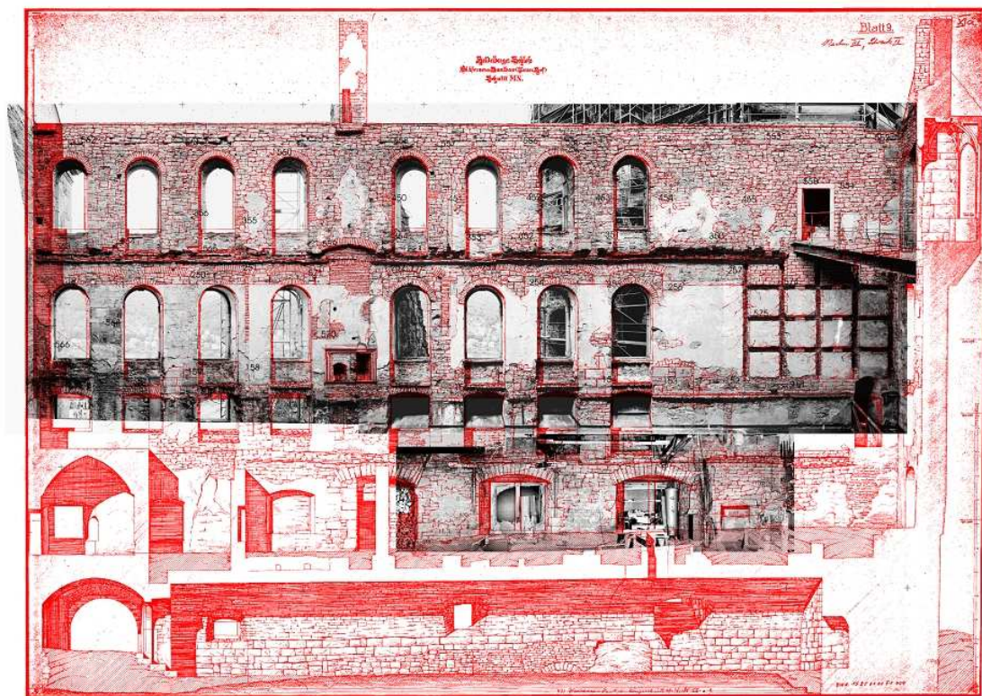
Abbildung 9: Schloss Heidelberg, Gläserner Saalbau – Beispiel einer Überlagerung eines Orthophotos mit dem Bauaufnahmeplan von Koch und Seitz (1883-89)
