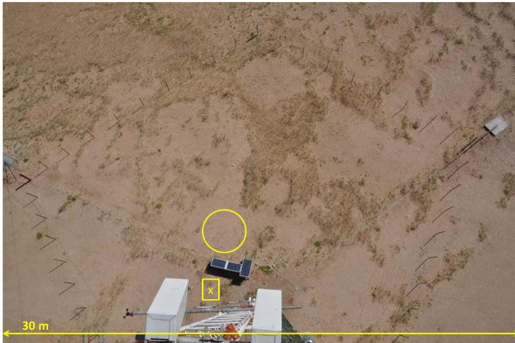
Abbildung 6.4.: Position und Messfläche des mobilen Mastsystems während der Parallelmessung am 10. 03. 2010 (abgeändert aus [175]). Die Position des Teleskopmasts ist mit einem gelben "X" gekennzeichnet. Der gelbe Kreis markiert die Messfläche von  $0,23 \text{ m}^2$  und deren weitere Umgebung, da die exakte Position der Messfläche nicht bekannt ist.
