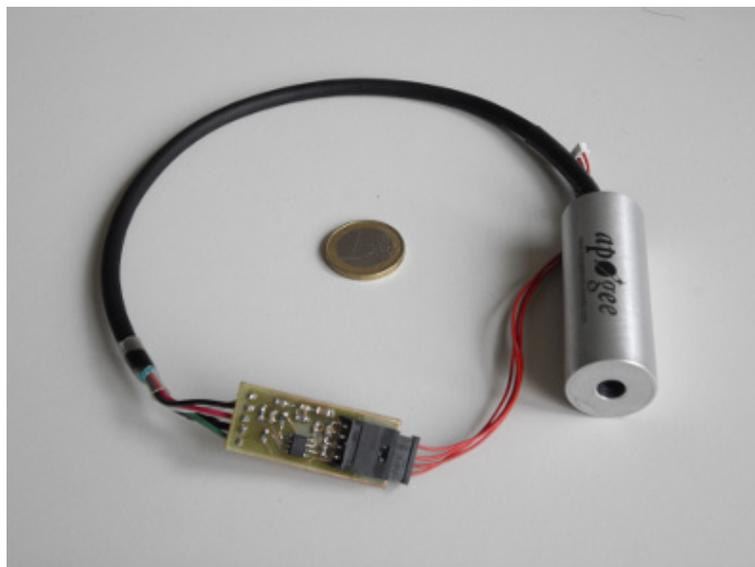
Abbildung A.5.: Das Infrarotradiometer Apogee IRR-PN mit Verstärkerschaltung zur Integration in das UAV-System
