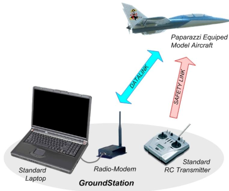
Abbildung A.1.: Schematischer Aufbau eines Paparazzi UAV-Systems (aus [183])
