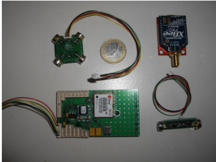
Abbildung A.4.: Instrumentierung für das Autopilotsystem Paparazzi: Autopilotplatine (links unten), Funkmodul (rechts oben), Infrarotsensoren zur Bestimmung der horizontalen (links oben) und vertikalen (rechts unten) Lage des UAVs
