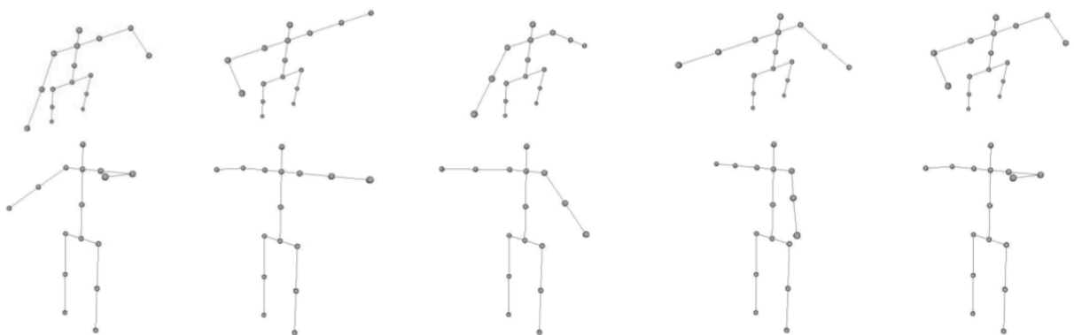
Abb. 2.4.: Details zum Trackingsystem von Mühlbauer: Auswahl der verwendeten typischen Posen. Bildquelle: [Mühlbauer et al., 2008].
