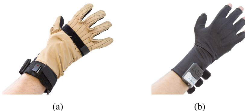
Abb. 2.14.: Zwei typische Datenhandschuhe: (a) Datenhandschuh CyberGlove II mit 22 Freiheitsgraden. (b) Datenhandschuh 5DT Data Glove 5 Ultra mit 5 Freiheitsgraden.
