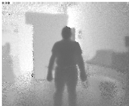
Abb. 5.2.: Tiefenbild einer Szene, in der ein Mensch im Vordergrund steht. Erhalten als z-Koordinate einer Aufnahme mit einem Swissranger 3000-Sensor.
