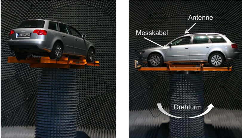
Abbildung 6.12: Foto des Institutsfahrzeuges in der Antennenmesskammer
