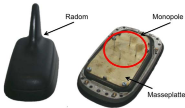
Abbildung 6.8: Aufbau des zirkularen Monopollarrays
