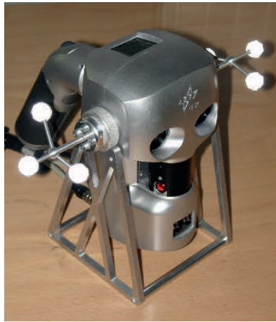
Abb. 2.5. 3DMo-System des DLR (Quelle: http://www.dlr.de/rm/en/portaldata/52/Moduledata/7983/sv_503_1_1.jpg ).
