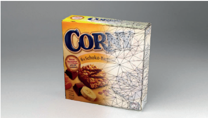
Abb. 5.20. Ziel des Texturierungsprozesses: Dreiecksnetz mit Farbinformation aus Objektansichten.
