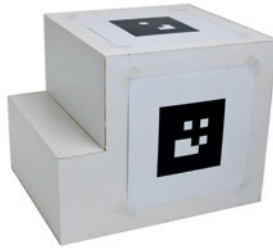
Abb. 5.9. Kalibrierobjekt zur Bestimmung der Kameraposen.
