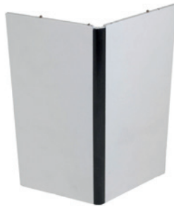
Abb. 5.8. Kalibrierobjekt um die Rotationsachse des Rotationstellers zu bestimmen.
