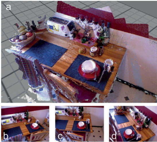
Abb. 8.16. Szene aus dem Trainingsdatensatz der Szenenmodellierung am Beispiel „Frühstückstisch“. a) 3D-Punktwolke b-d) 2D-Bilddaten.
