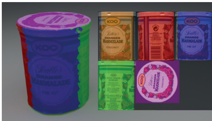
Abb. 8.6. Veranschaulichung der Texturierung aus verschiedenen Ansichten. Farblich codiert sind die einzelnen Ausgangsbilder, die zur Gesamttextur fusioniert wurden, mit ihrer Position auf dem Dreiecksnetz.
