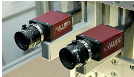
Abb. 5.5. Stereokamerasystem auf Schlitten im Modellierungcenter verbaut.
