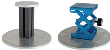
Abb. 5.3. Aufsätze für den Rotationsteller. Links: feste Höhe, rechts: höhenverstellbar.
