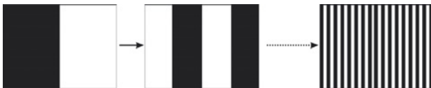
Abb. 3.6. Mögliche Abfolge eines zeitlich codierten Streifenmusters.
