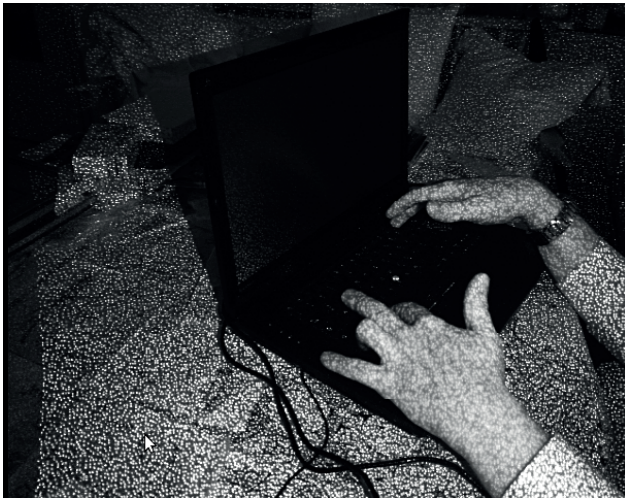
Abb. 3.8. Infrarot-Rauschmuster des Kinectsensors. Quelle: [Wikipedia, E. - User:Kolossos 12].
