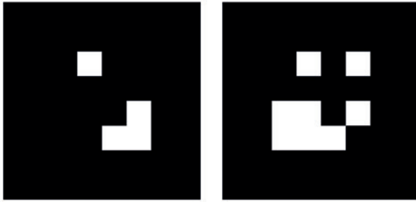
Abb. 5.11. Die auf dem Kalibrierobjekt angebrachten Marker. Links: ID=2, rechts: ID=10.
