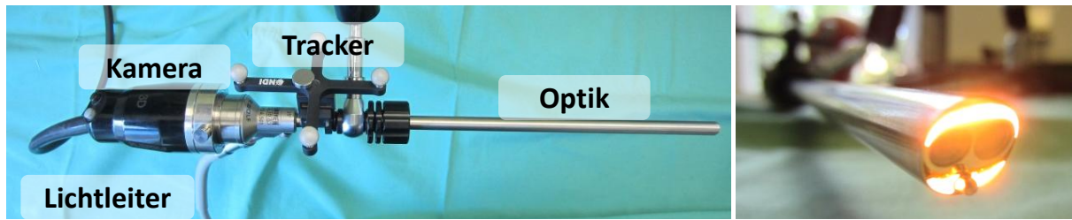
Bild 2.4: Aufbau eines Stereo-Endoskopes (mit optionalem Tracker zur Verfolgung der Position durch ein Trackingsystem)
