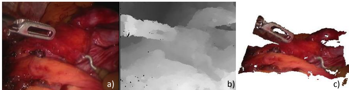
Bild 1.2: Oberflächenrekonstruktion aus Bildern eines Eingriffes mit dem daVinci-Telemanipulator: a:) Linkes Kamerabild; b): Disparitätsbild, das die Entfernung eines Punktes als Grauwert kodiert; c): rekonstruierte Punktwolke
