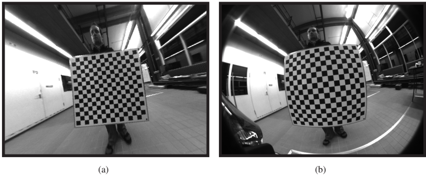
Abb. 2.6: Links : Extreme radiale Verzeichnung durch Weitwinkelobjektiv. Rechts : Kompensation der radialen Verzeichnung durch Berücksichtigung der intrinsischen Parameter (Linsenverzeichnung) nach Kalibrierung/Rektifizierung.
