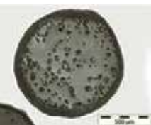
OM & SEM - Be pebble T_{irr} = 675^{\circ}C
