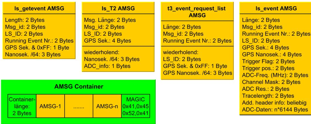
**Abbildung 8.5:** In Gelb die Datenstrukturen der wichtigsten AMSGs zur Kommunikation mit und innerhalb der AERA-DAQ. Zusätzlich sind die Datenbreiten der mitgesendeten Werte vermerkt. In Grün die Struktur des AMSG-Containers zum Transport der AMSGs.
