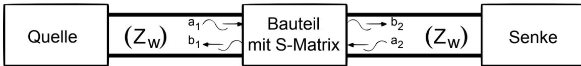
**Abbildung B.7:** Schematische Darstellung eines durch S-Parameter beschriebenen Bauteils mit über Wellenleiter angeschlossener Quelle am Eingang bzw. Senke am Ausgang.
