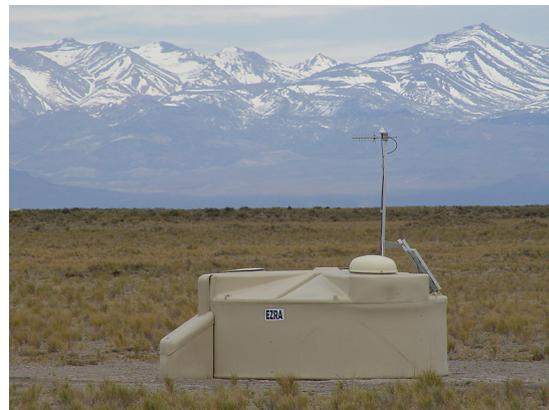
**Abbildung 3.2:** Skizze eines Wasser-Tscherenkow-Detektors von SD [45] (links). Bild eines Detektors im Feld (rechts).
