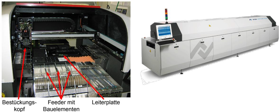
**Abbildung 6.15:** Bestückungsautomat der AVT-Gruppe (links). Reflow-Lötofen zum Aufschmelzen der Lotpaste [137] (rechts).
