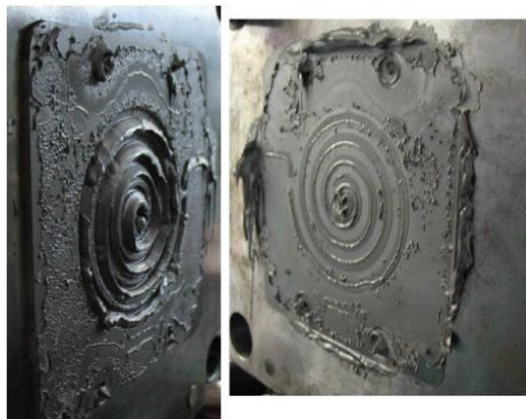
Abbildung 5.1: Fließspiralkavität nach Einspritzen bei Werkzeugtemperaturen von 130 °C/95 °C [85]
