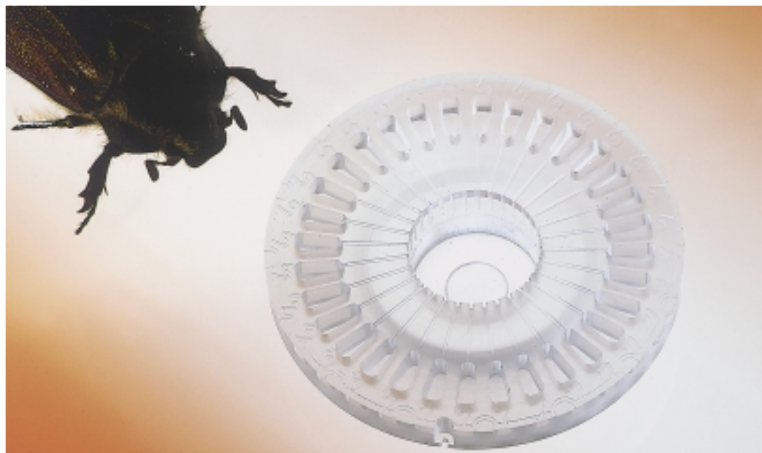
Die BioDisk, das erste von MikroWebFab entwickelte und gefertigte Mikrosystem, kann an einem Blutstropfen 32 Analysen gleichzeitig durchführen.
