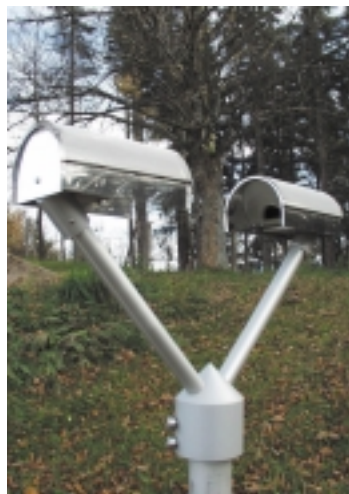
Disdrometer der Firma PMTech zur Niederschlagsbeobachtung.
