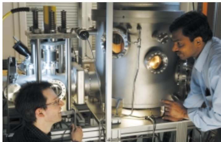
In der Edelgaskondensationsanlage im Institut für Nanotechnologie des Forschungszentrums Karlsruhe werden nanostrukturierte Partikel, beispielsweise aus Platin, hergestellt.
