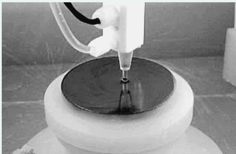
Die Megasonicsysteme der Firma Sonosys werden bei der nasschemischen Prozessierung von Halbleiter-Wafern (Foto), Substraten und Mikrosystemen eingesetzt.
