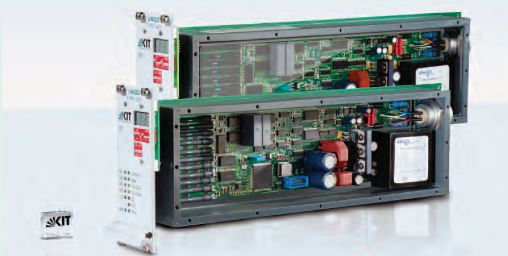
Ein neu entwickelter Quench-Detektor UNIQUD vom Typ 3420/3420-HV.
