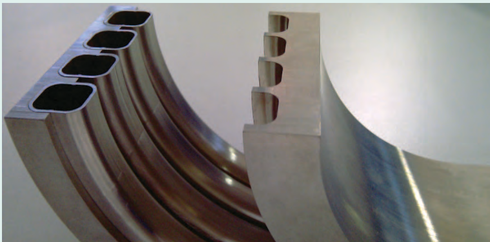
Sicheres Verschweißen von gekrümmten Bauteilen mit Hohlkörperstrukturen.
