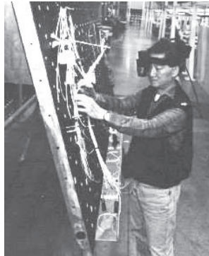
Abbildung 2.20: AR-basierte Herstellung von Kabelbäumen [420]
