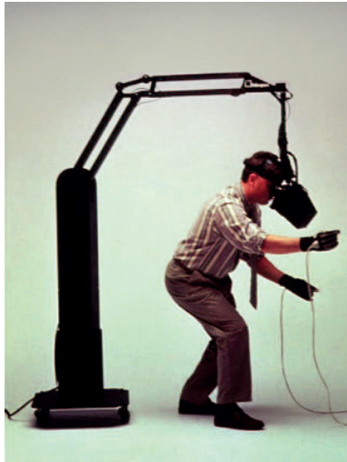
Abbildung A.5: Tracking mithilfe des „Boom-Devices“ [84]
