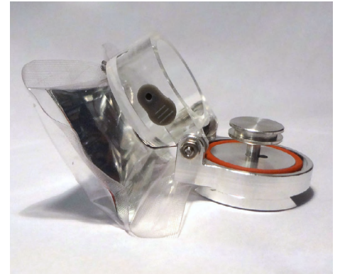
Die Dose ist unter Raumbedingungen (links) geschlossen und öffnet sich im Vakuum (rechts) automatisch.
