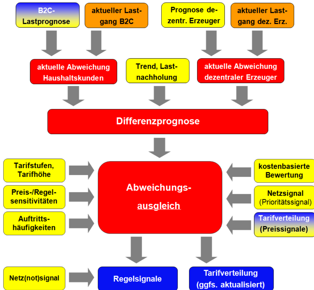
Abbildung 5.3: Schematischer Aufbau des Modells zur Generierung der relativen Regelsignale
