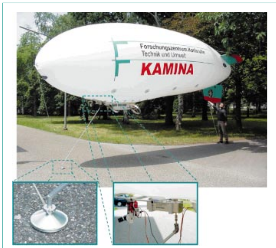
Abb. 1. Das funkferngesteuerte Luftschiff mit elektronischer Nase LENA mit Videokamera und Ansaugrohr zur bodennahen Probenahme.
