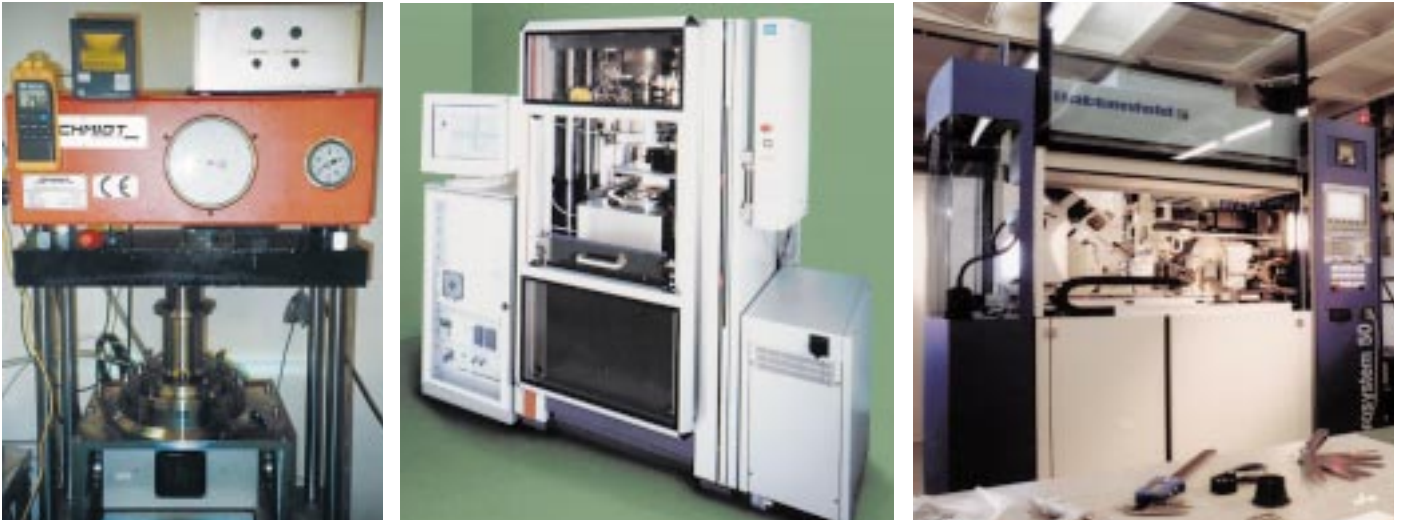
Abb. 4: Die unterschiedlichen Einsatzfelder spiegeln sich auch in der Maschinenausstattung wider. Links die Versuchsanlage für den UV-RIM-Prozess. In der Mitte eine manuell zu bestückende Heißpräganlage Hex03 der Firma Jenoptik für Laborbetrieb und Vorserienfertigung. Rechts die Battenfeld Microsystem 50 mit 5t Schließkraft, ausgelegt zum vollautomatischen Spritzgießen kleinster Bauteile mit integrierter Teileentnahme und Magazinierung.
