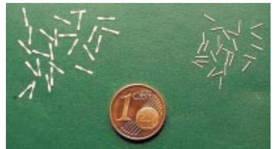
Abb. 3: Prüfkörper mit minimalem Querschnitt von 200 µm x 200 µm für Mikro-Zug- (links) und -Biege-Versuche (rechts), hergestellt durch Hochdruck-Keramik-Spritzgießen (HP-CIM) aus ZrO 2 -Keramik.
