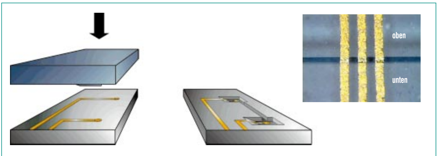
Abb. 3: Prägen von Leiterbahnen zur elektrischen Kontaktierung. Das Verfahrensprinzip lässt erkennen, dass nach dem Prägen die Leiterbahnen im Polymer vergraben sind. Rechts im Bild ist zu sehen, wie die Leiterbahnen über eine 45°-Kante (im Bild dunkel) einen Höhenunterschied von über 100 µm überwinden.
