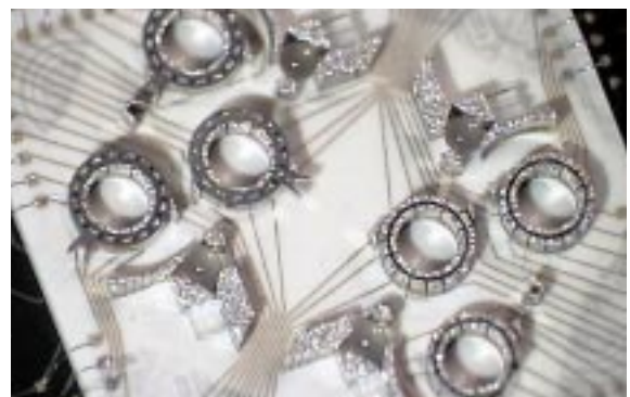
Optischer Schalter [9] 500 \mu\text{m} Höhe, 20 \mu\text{m} Breite, Ni-Galvanik
