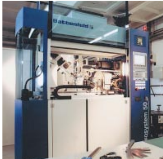
Abb. 2: Anlage für das Hochdruck-Keramik-Spritzgießen (HP-CIM): Spritzgießmaschine Battenfeld Microsystem 50 (links) mit Spritzgießwerkzeug (rechts): Standfläche ca. 2 m 2 , Schließkraft 50 kN.
