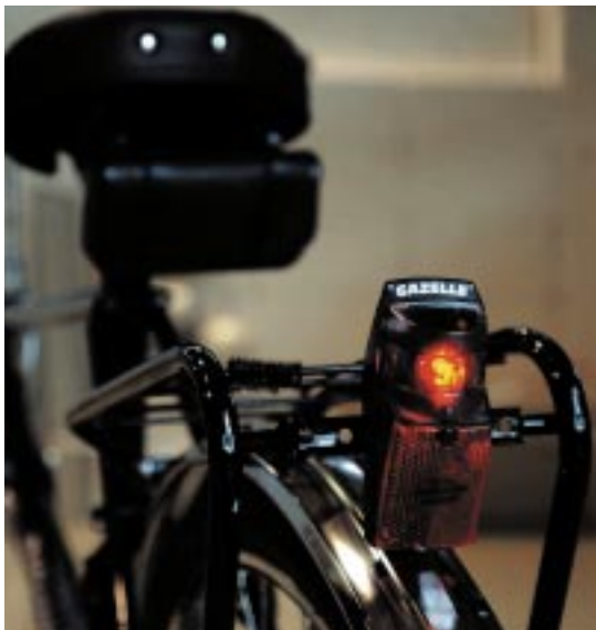
Abb. 2: vollautomatisches Fahrradrücklicht mit FZK-Mikrovibrationsschalter.
