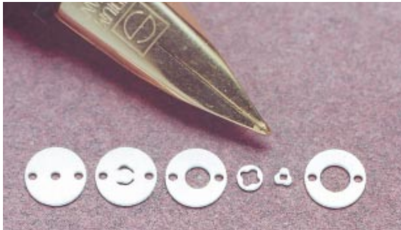
Abb. 4: Komponenten einer Mikro-Zahnringpumpe aus Oxidkeramik mit minimalen Wandstärken von 100 µm und einer Strukturhöhe von 300 µm.
