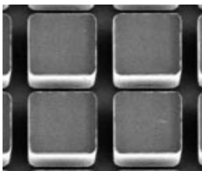
Abb. 5: Detailaufnahme eines Formeinsatzes aus galvanisiertem Nickel. Die Quadrate sind etwa 50 µm breit. Der Resist wurde durch Laserablation entfernt.
