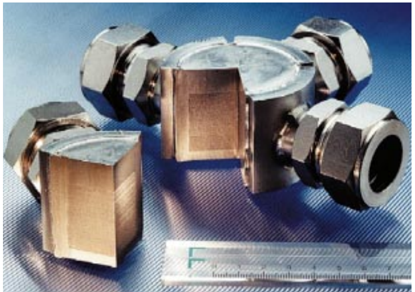
Abb. 2: Technische Ausführung eines Mikrostrukturapparates aus Edelstahl für große, industrielle Stoffdurchsätze für verfahrenstechnische Anwendungen. Der innere Kern des Apparates ist ein würfelförmiger Körper mit 3 cm Kantenlänge. Er enthält insgesamt 15 000 Mikrokanäle, die auf zwei Passagen aufgeteilt sind. Mit Wasser als Testmedium können bis 7 000 Liter pro Stunde durch die Mikrokanäle der einen Passage gepumpt werden und dabei bis zu 200 Kilowatt Wärmeleistung auf die Kühlflüssigkeit in der im Kreuzstrom verlaufenden zweiten Passage übertragen werden.
