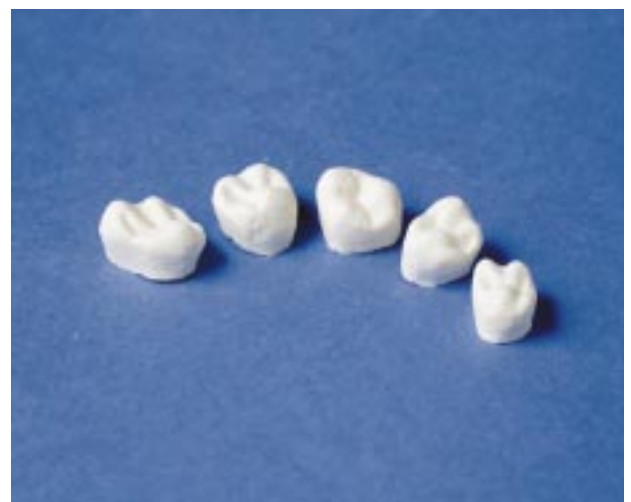
Abb. 6: Gefräste, passgenaue Dentalkronen vor dem Reaktionssintern (links) und danach (rechts).
