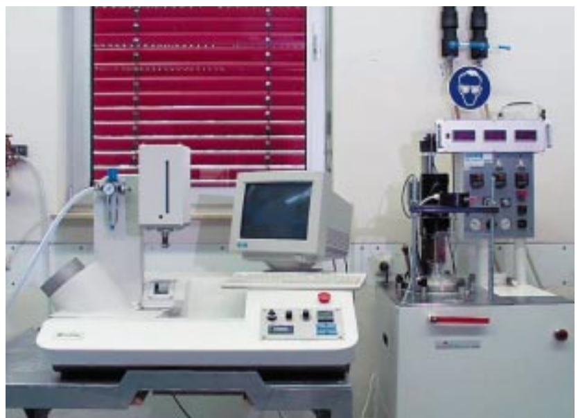
Abb. 6: Anlagen für das Niederdruck-Keramik-Spritzgießen (LP-CIM): links GOCERAM GC-MPIM-2-MA-X, rechts Peltzman MIGL-33.
