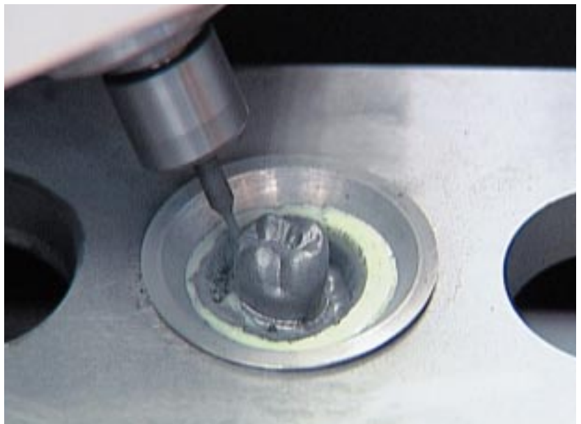
Abb. 5: Fräsen einer Zahnkrone aus einem Strukturkeramik-Grünkörper mit dem KaVo-Everest-System, nach [15].
