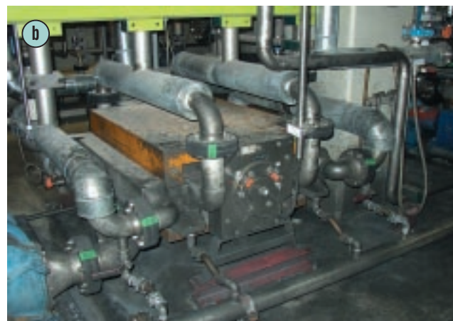
Abb. 2: Fotos der derzeit größten Ausführung des Hochgradienten-Magnetseparators Typ HGF mit zwei Abscheidematrizes von je 1 m Länge. a) Zwei HGF 100-2 während der Fertigung. b) HGF 100-2 inklusive Verrohrung während des Einsatzes in einem Walzwerk.
