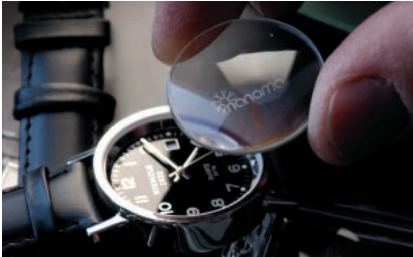
Abb. 3: Antireflexbeschichtetes Uhrenglas mit „Antireflex-Wasserzeichen“ (nanomat-Logo), welches nur in Reflexion – also nur unter einem bestimmten Betrachtungswinkel – zu sehen ist.
