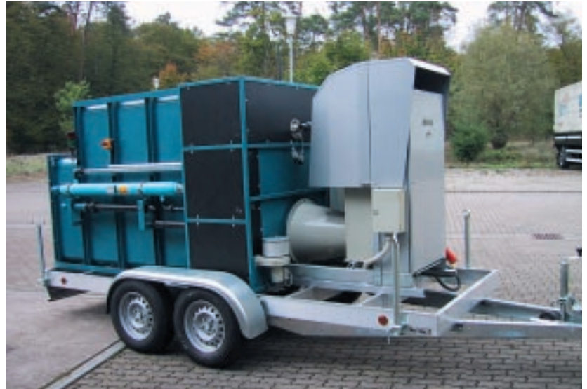
Abb. 1: Mobile Maischeporationsanlage KEA-Wein.
