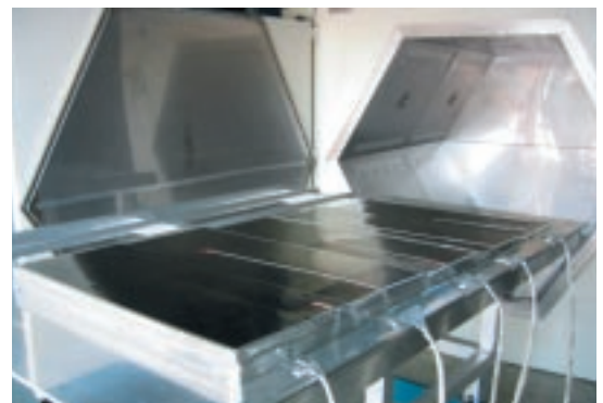
Abb. 5: Der HEPHAISTOS-CA2 vor der Aushärtung einer Großstruktur in einem metallischen Werkzeug der EADS.
