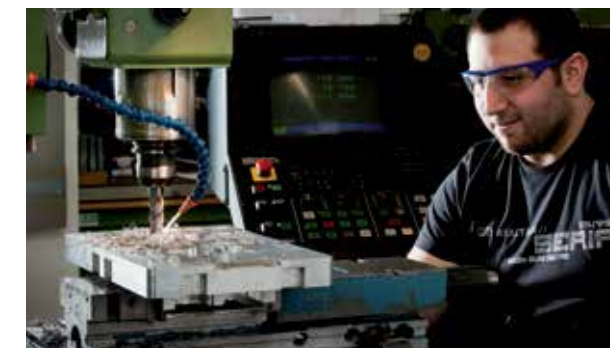
Präzisionsfertigung von Bauteilen für die Motorenforschung
