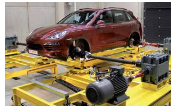
Anwendungsbeispiel für Vehicle-in-the-Loop. Untersucht wird das Gesamtfahrzeug, der Reifen-Fahrbahn-Kontakt und der Straßenverlauf sind in der Simulation abgebildet.
