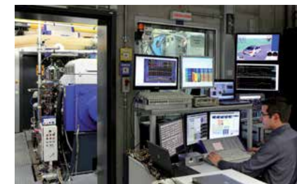
Beispiel zum Prinzip der Engine-in-the-Loop-Methode bei der Untersuchung eines Verbrennungsmotors; Bild: Silke Voss Fotografie, Karlsruhe
