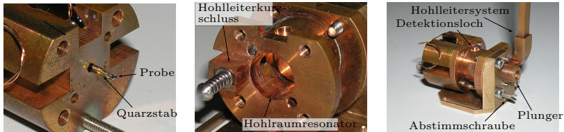
(a) Probenhalter mit (b) Blick in den zylindrischen Resonatorhohlraum sonator mit optischem Zugang und elektrischem Kopplungsloch und (c) fertig montierter Resonator mit Plunger und Abstimmerschraube. Die einzelnen Komponenten können fest miteinander verschraubt werden (vgl. Hohlleiterkurzschluss, Abb. 6.1(a)).
