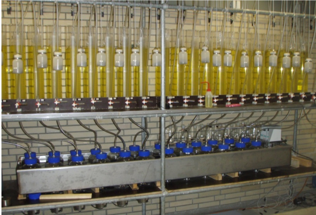
Abbildung 5.4: Aufbau der 2 Liter-Batch-Gärversuchsanlage
