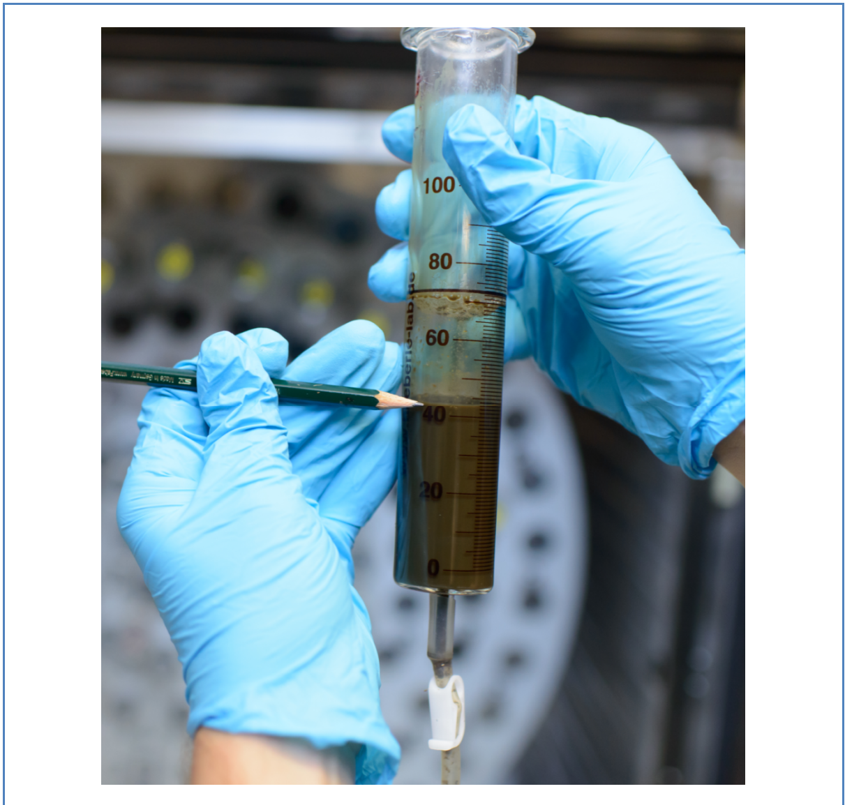
Abbildung 5.1: Gefüllter Kolbenprober des HBT mit Inokulum und Testsubstrat
