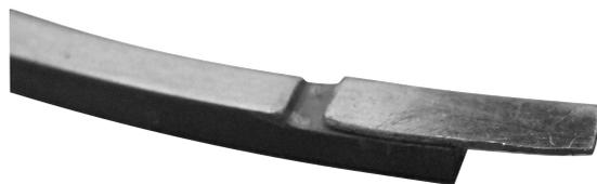
**Abbildung 6.15** Kolbenring mit überlappendem Stoß
