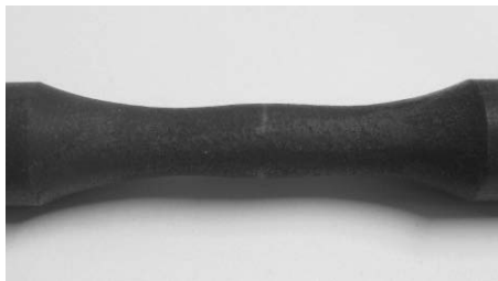
Abb. 6.10: Fassbildung an einer Probenmessstrecke nach 372 Lastwechseln ( \approx 97\% N_A ) unter OP-Beanspruchung mit t_H = 2 min und \varepsilon_{a,t}^{me} = 0,5\%
