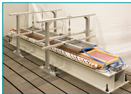
Abbildung 4: Der Linearmotor-Demonstrator auf dem Antriebssystemprüfstand.
