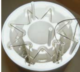
Abbildung 3.8: Thermosäule bestehend aus acht Ringen mit acht Pt-Pt13Rh Thermoelementen in Reihe verknüpft.
