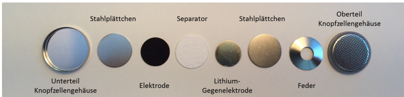
Abbildung 6.3: Bestandteile der in dieser Arbeit eingesetzten Knopfzelle des Typs 2032.
