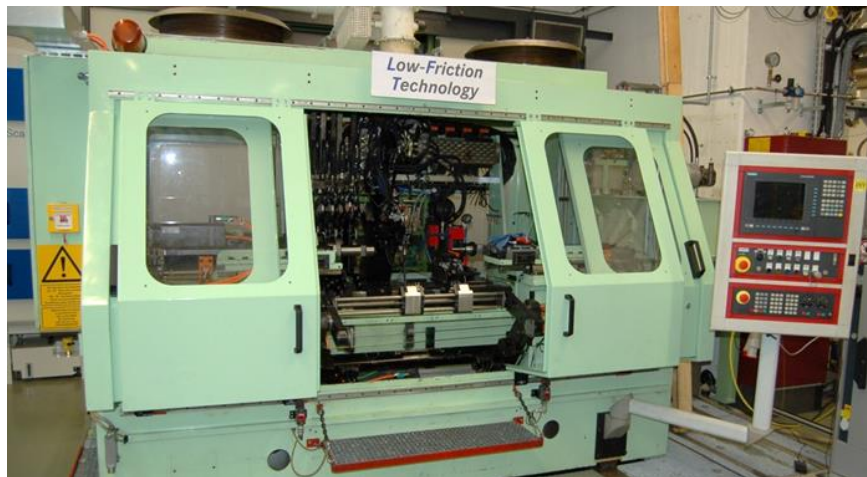
Bild 4.1: Außenrundlappanlage zum automatisierten Polymerlappen von Wellenbauteilen.
