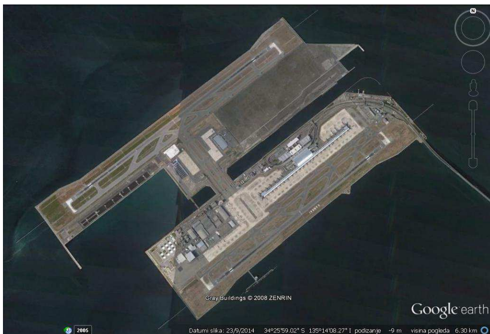
Slika 6.1 Zračna luka u Kobe-u, Japan, izgrađena na umjetnom otoku (nasipu)
