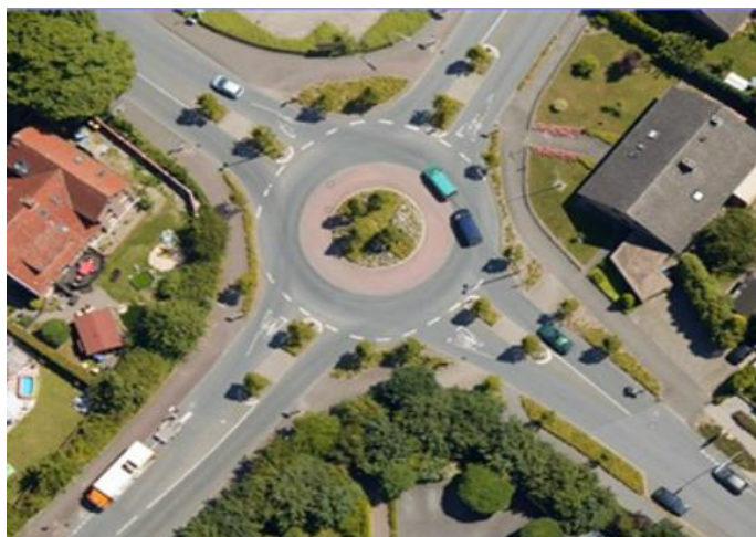
Slika 15: Kružni tok bez pješačkog prijelaza
