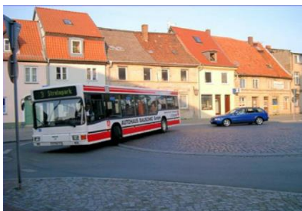
Slika 7: Autobus koji prelazi preko centralnog otoka
