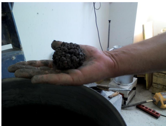
Slika 4.21. Ispitivanje konzistencije mješavine K 7
