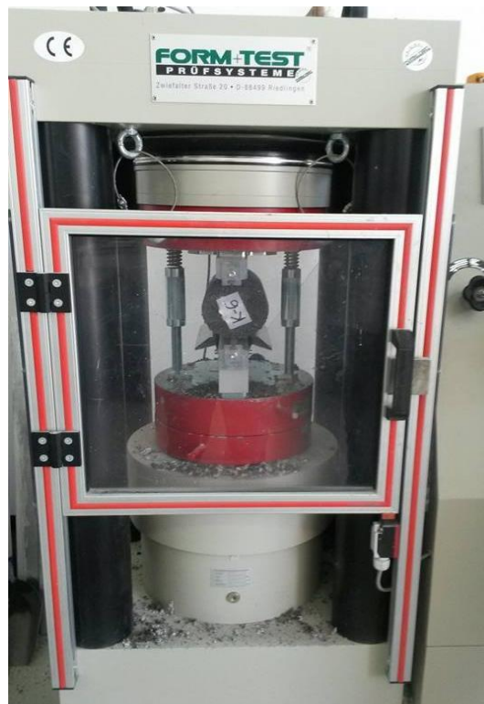
Slika 4.14. Preša za ispitivanje vlačne čvrstoće cijepanjem
