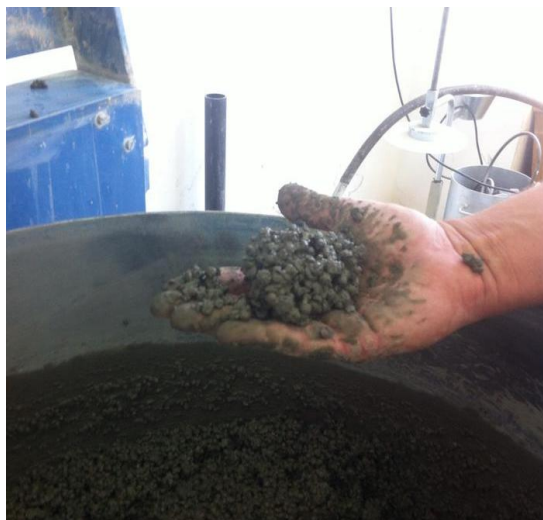
Slika 4.16. Ispitivanje konzistencije mješavine K_2
