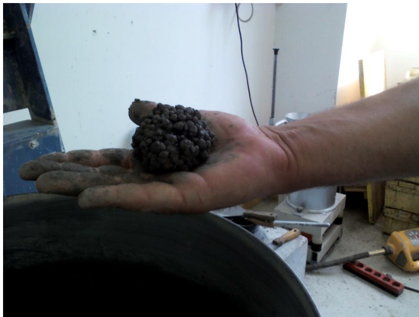
Slika 4.9. Ispitivanje konzistencije metodom oblikovanja grudice
