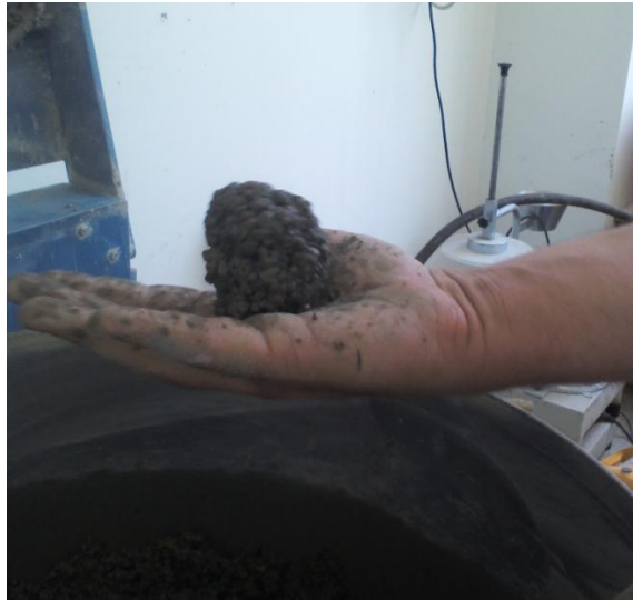
Slika 4.18. Ispitivanje konzistencije mješavine K 4
