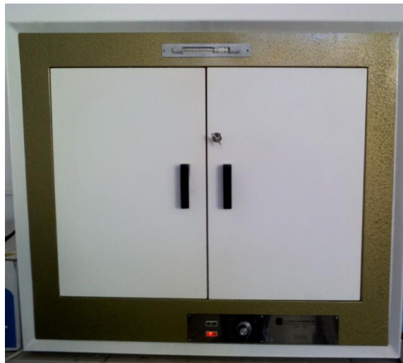
Slika 4.10. Uređaj za sušenje uzoraka
