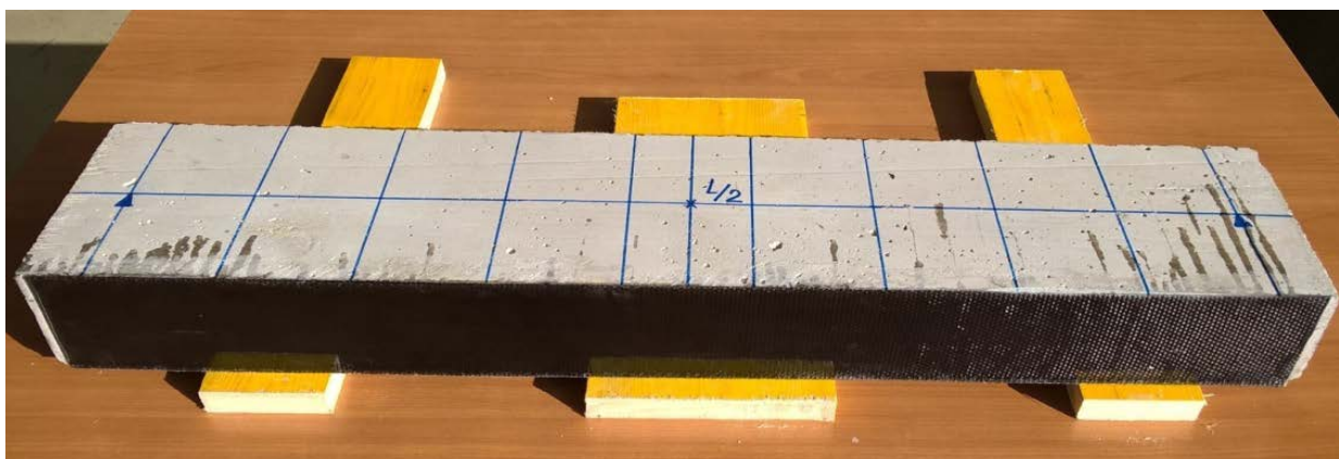
Fotografija 4.2: Greda G2 označena za ispitivanje
