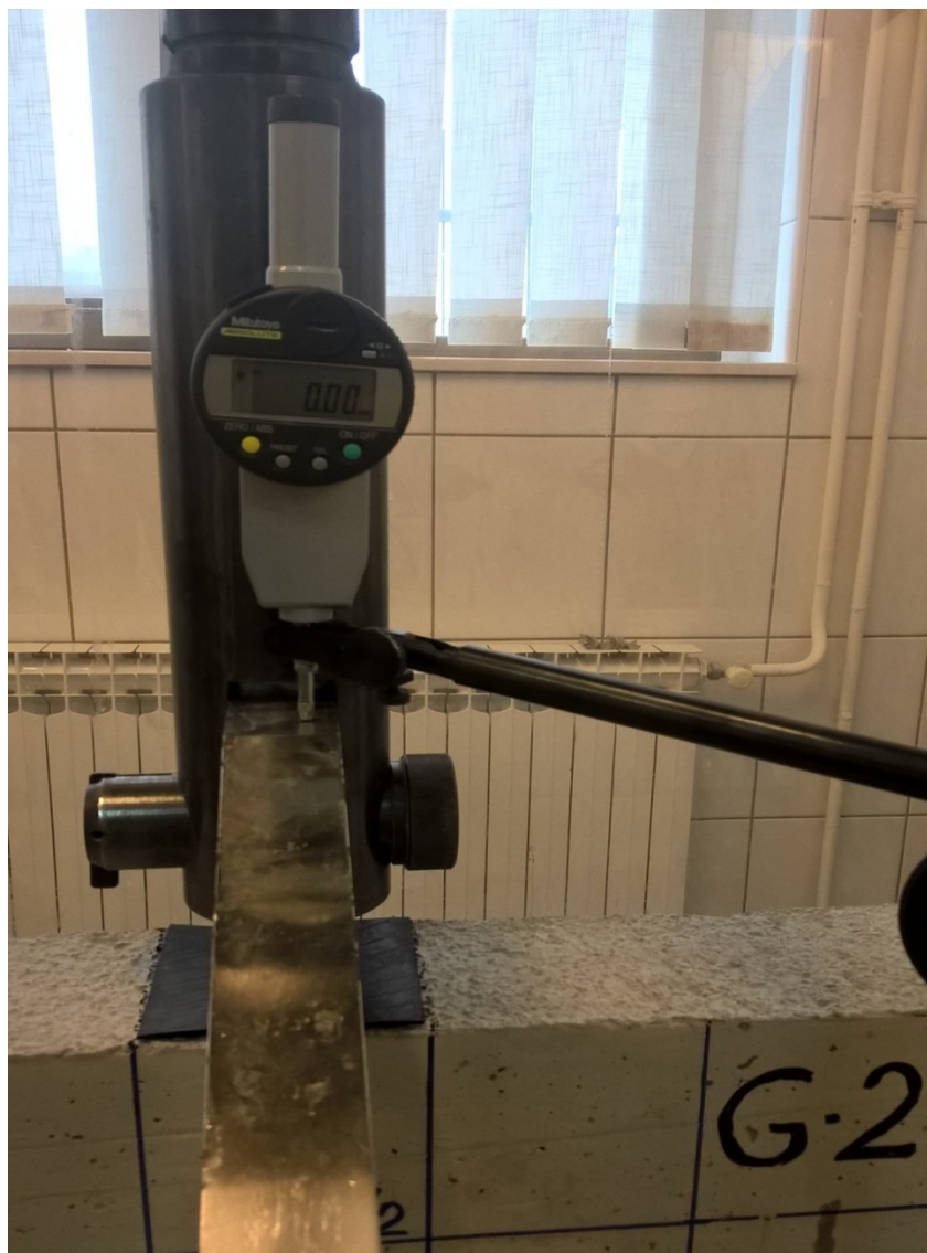
Fotografija 4.6: Slika postavljanja i nuliranja mikroure
