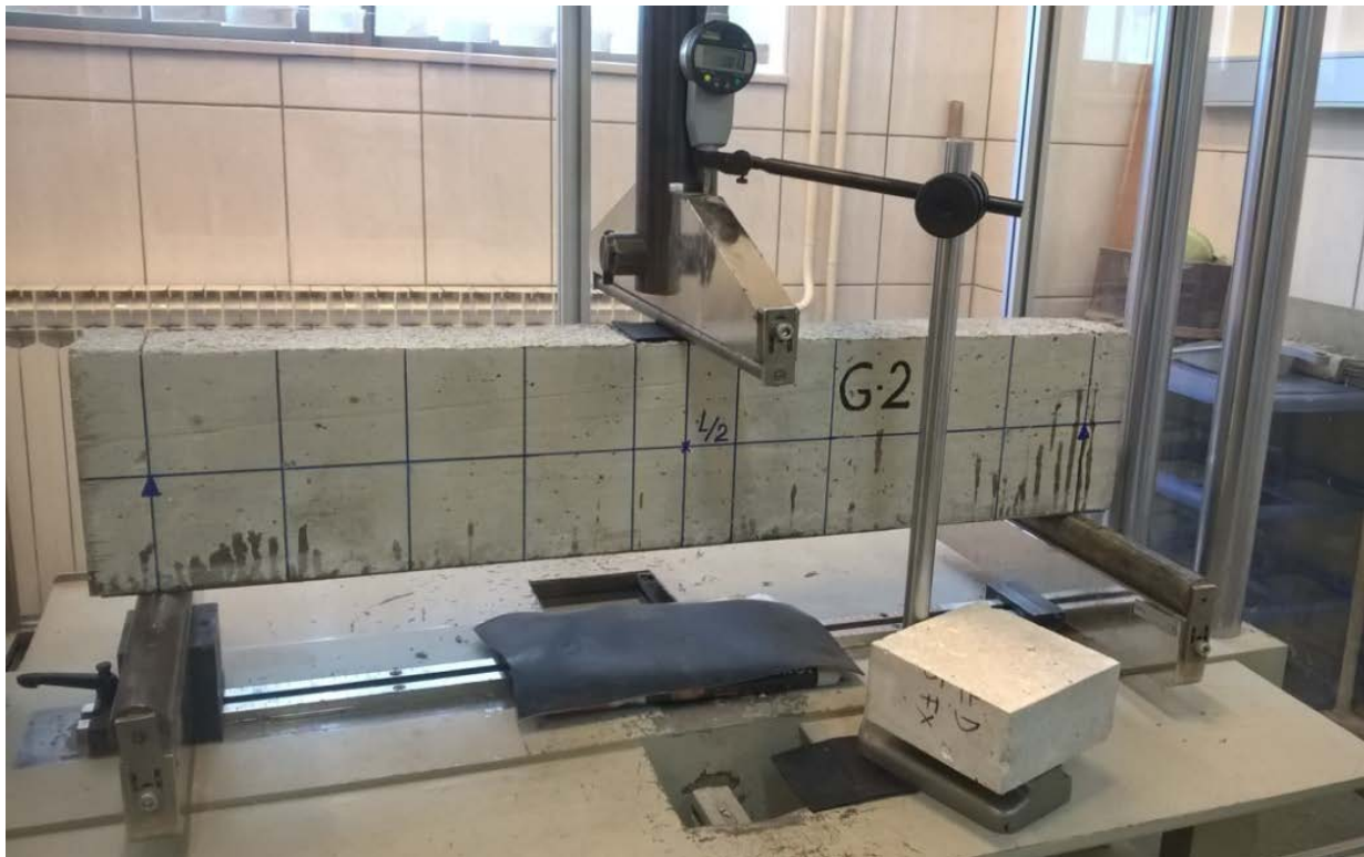
Fotografija 4.11: Početak ispitivanja grede G2 (ojačana karbonskom trakom)
