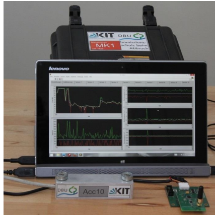
Abbildung 26: Messgraphen auf Tablett-PC, Beschleunigungssensor und Koordinator (ZigBee-Empfänger)
