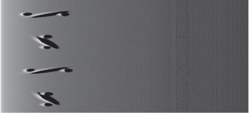
Abbildung 10.17: Eingabedaten für den Algorithmus: 100 simulierte Sidescan-Sonarlinien im linearen FM-Modus zu einem Bildstapel gestapelt. Die Daten werden zur besseren Sichtbarkeit logarithmisch dargestellt.
