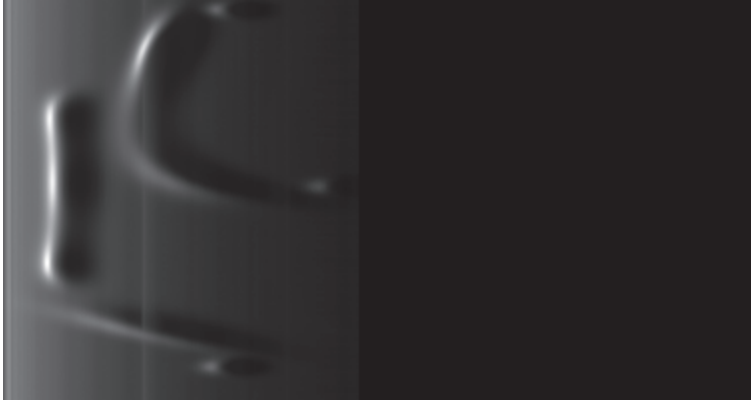
Abbildung 10.13: Eingabedaten für den Algorithmus: 100 simulierte Sidescan-Sonarlinien im FM-Basisband-Modus zu einem Bildstapel gestapelt.
