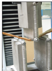
Obr. 3: Stanovení mezní síly při porušení tříbodovým ohybem
