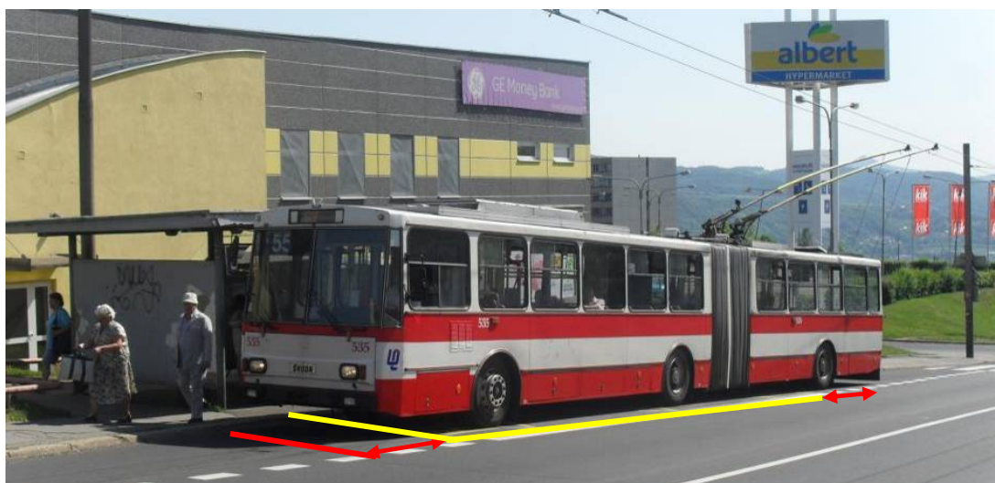
Obr. 4: Trolejbus Škoda 15Tr (18 m) u nástupní hrany o délce 12 m
