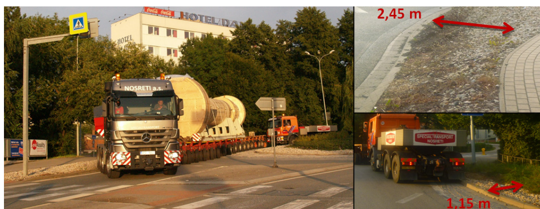
Obr. 4: Problematický průjezd okružní křižovatkou v Litomyšli (Foto: Ing. Petruš, Ing. Zeman)
