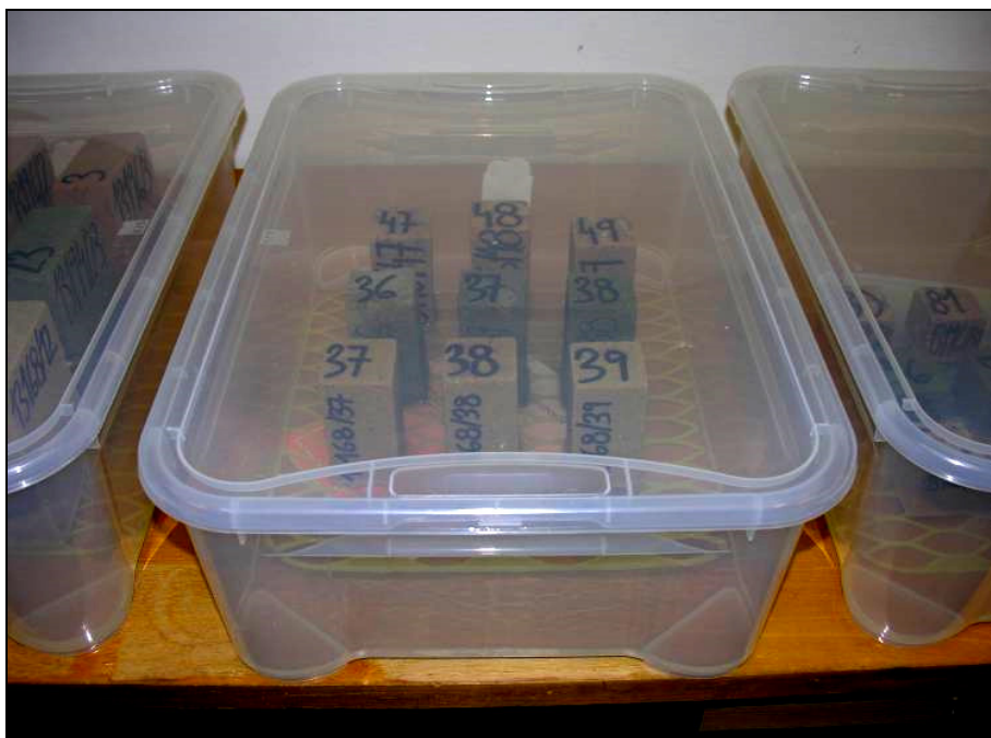
Obr. 2: Nasakování zkušebních pískovcových hranolů (50×50×100 mm) při výšce hladiny vody 2-3 mm
