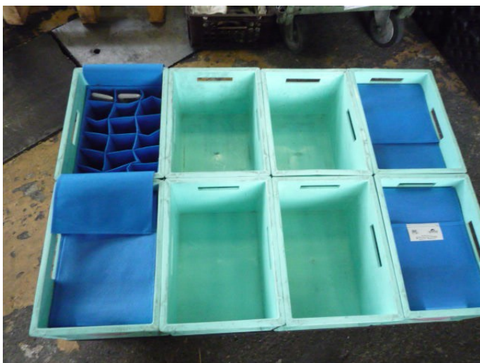
Obr. 45. Plánované balení výlisků. Každý výlisek má přihrádku.
