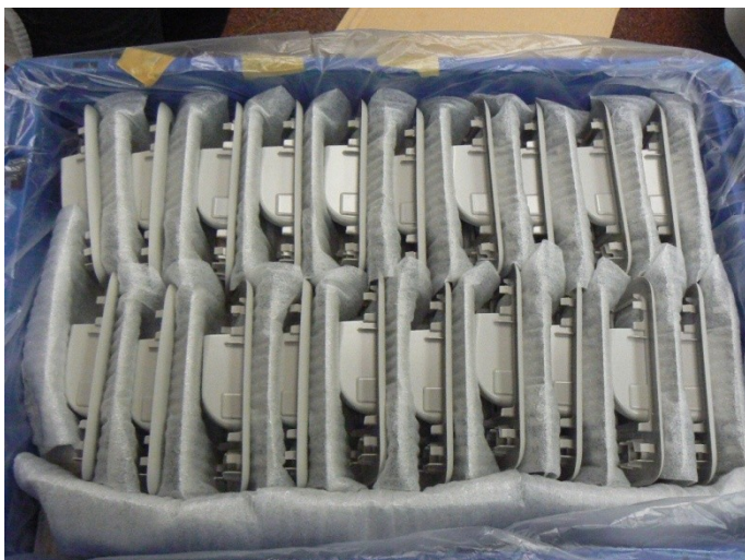
Obr. 46. Užívané balení výlisku. Každý výlisek je zabalen v miralonu.
