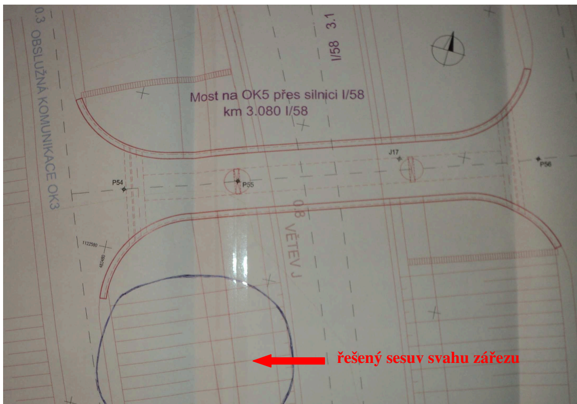
Obrázek 7: Situace mostního objektu s vyznačeným místem sesuvu svahu zářezu, [4]
