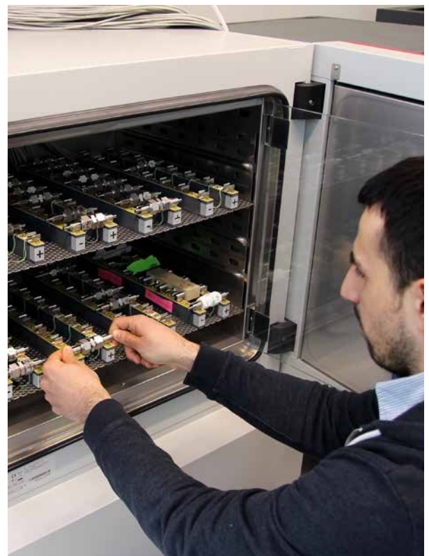
Galvanostatische Zyklierung von Lithium-Ionen-Batterien am HIU unter Verwendung von modifizierten Swagelok-Zellen
