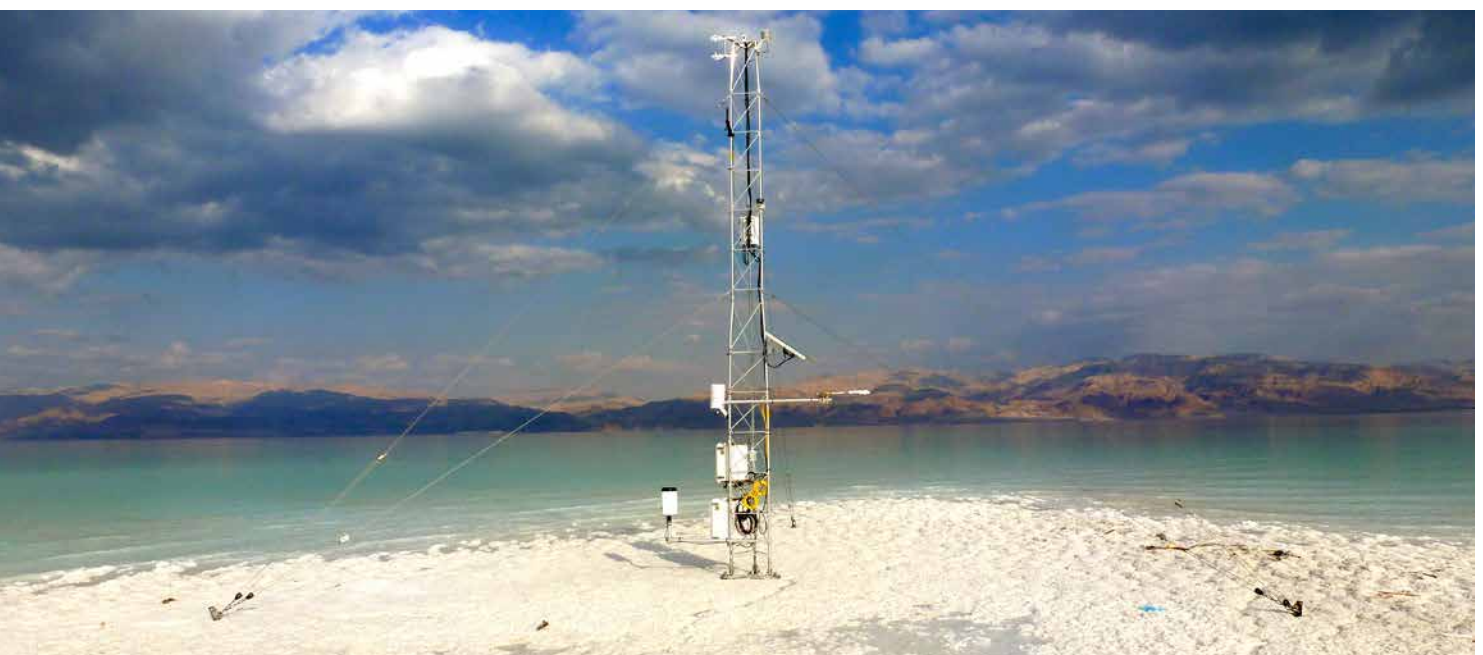
Die tiefstgelegene meteorologische Messstation der Erde: Direkt am Toten Meer steht ein sechs Meter hoher Messmast. Die Instrumente messen Strahlung, Verdunstung und Wärme
