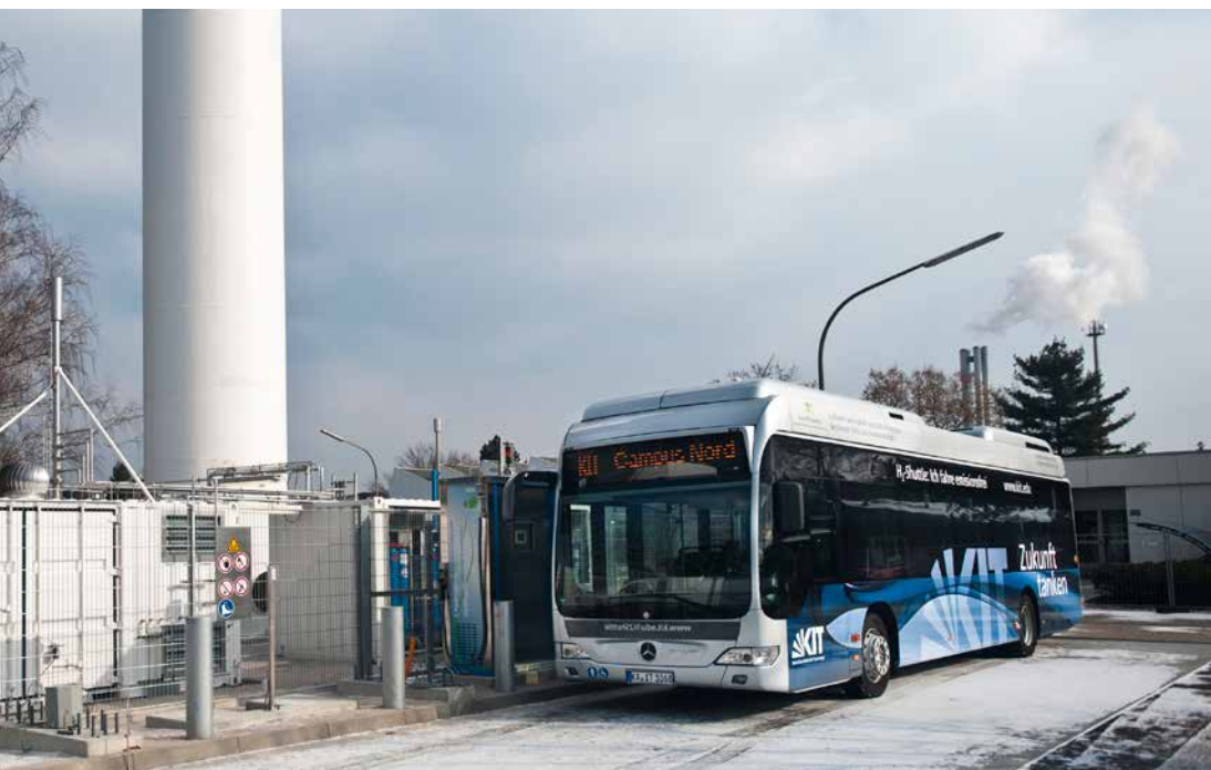
Einer der beiden Wasserstoff-Brennstoffzellenbusse des KIT legt einen Zwischenstopp an der Wasserstofftankstelle auf dem Gelände des Campus Nord ein
