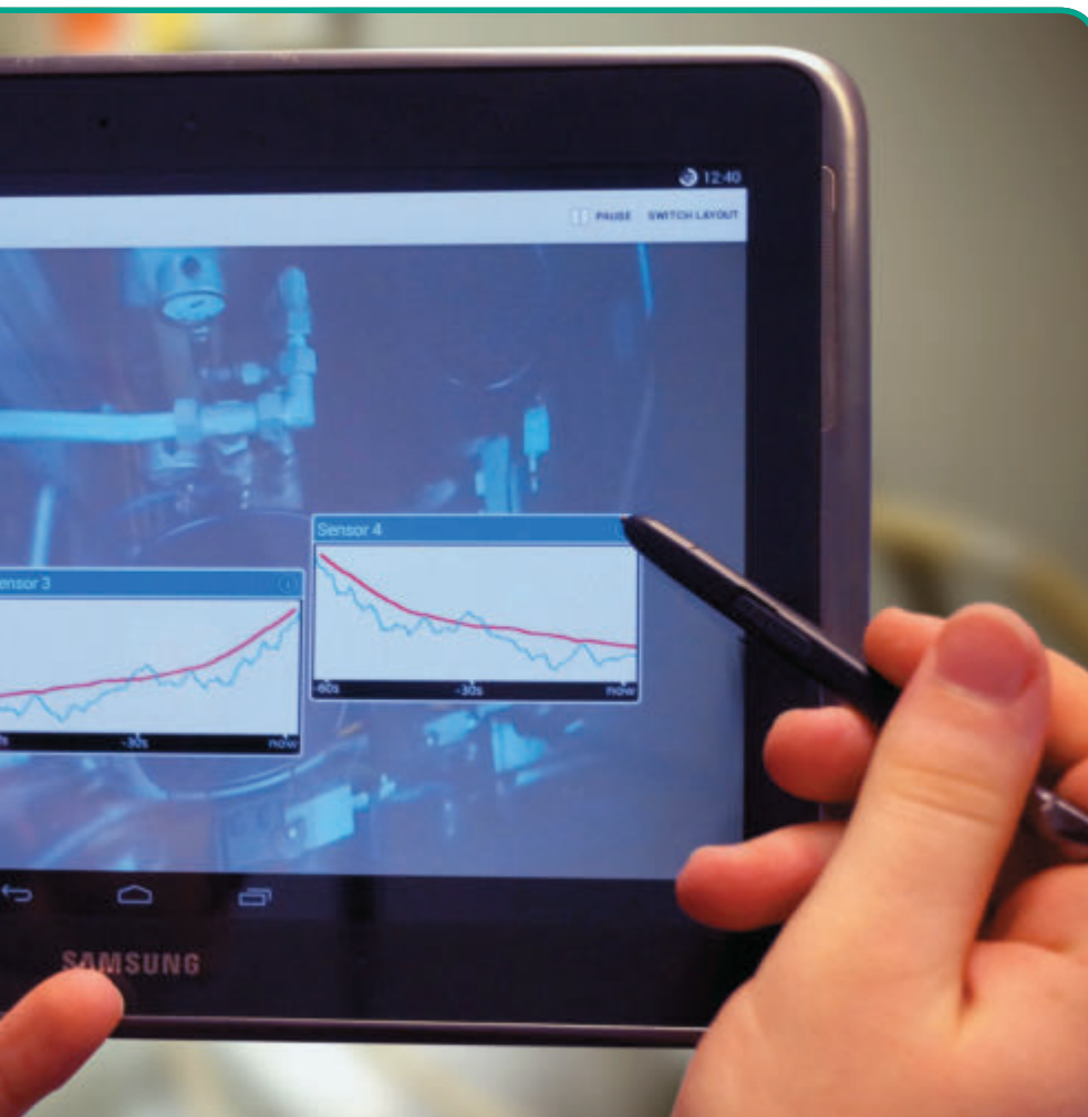
Sensordaten in Echtzeit in ein Kamerabild der Anlage eingespielt: So wird eine effizientere Fehlerdiagnose vor Ort möglich.
